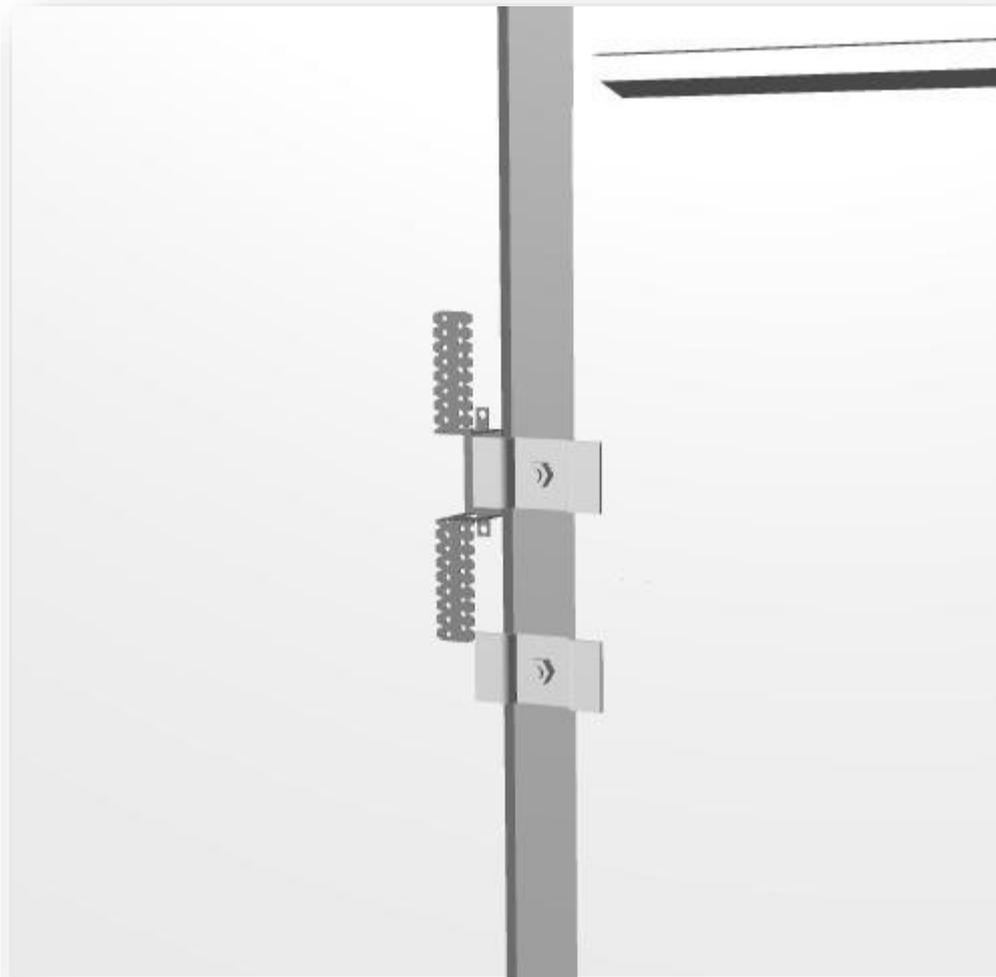
**Daran wird die Traglattung aus CD-Profilen (oder Dachlatten) mit passenden Schrauben angebracht wobei überstehende Bügel einfach umgebogen werden.**
