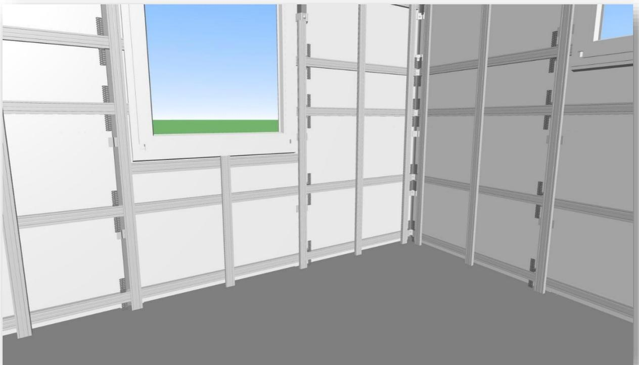
Die entstehenden Hohlräume werden mit Dämmung verfüllt. Wichtig: Vor dem Verplanken mit Gipskarton o. Ä. muss eine Dampfbremsfolie aufgebracht und sorgfältig ringsherum verklebt werden.
