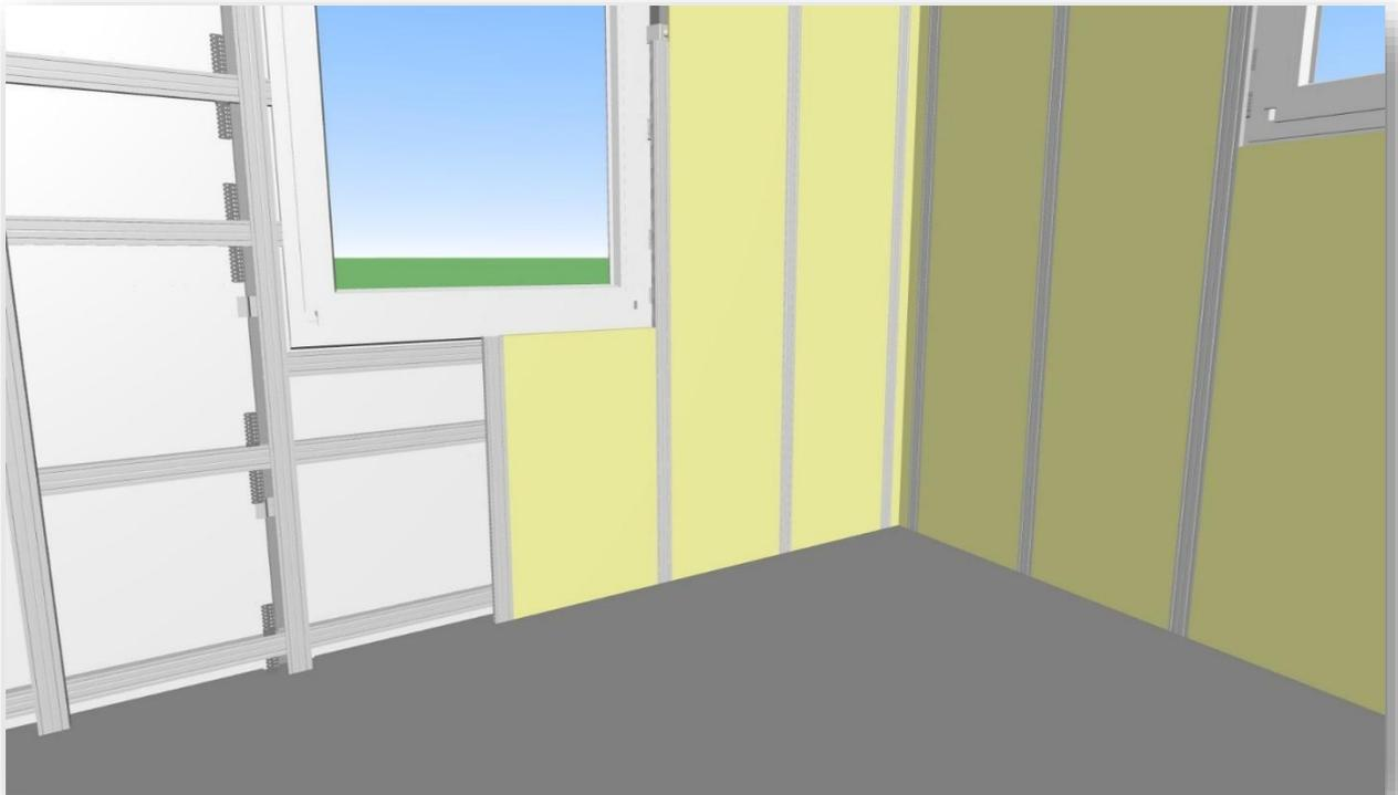
Durch die Folie werden dann die Bauplatten in die Schraubblattung verschraubt und entsprechend den Herstellerrichtlinien verspachtelt oder verfugt.
