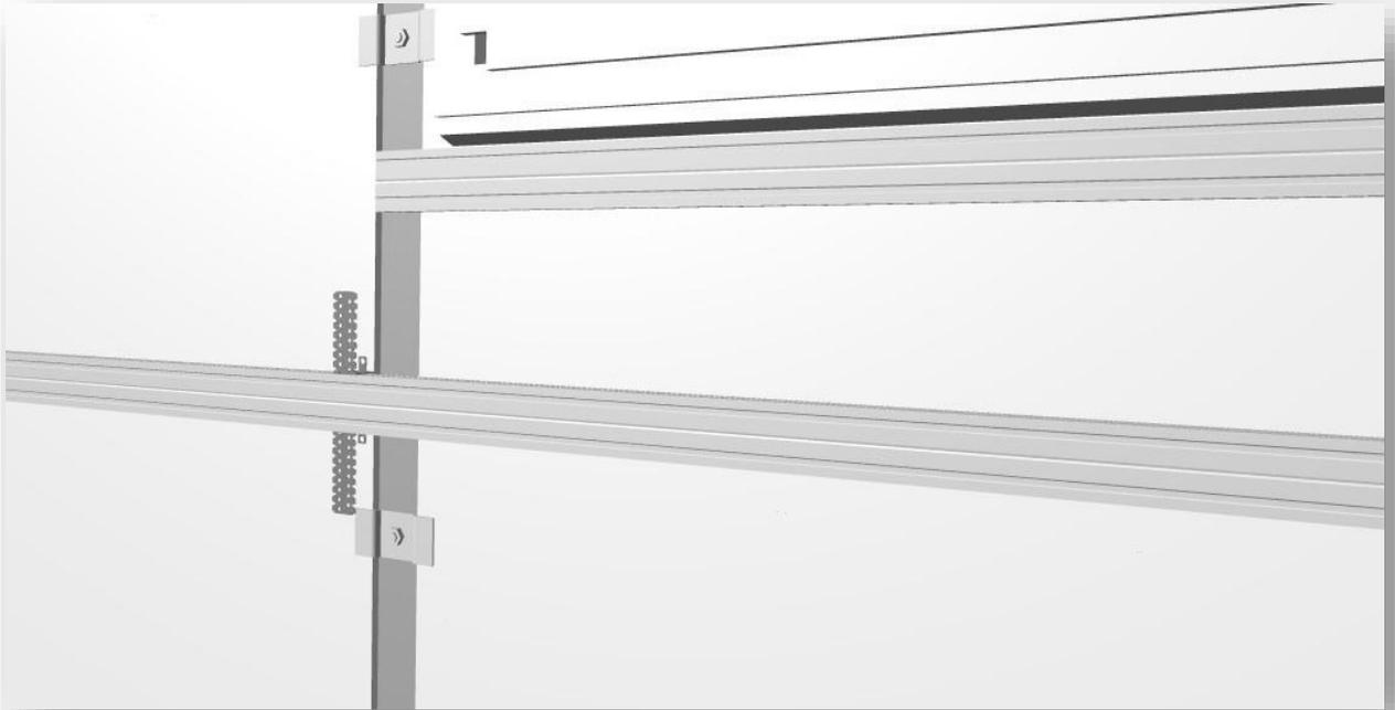
**Mittels Kreuz- und Längsverbindern wird die Schraubplatte aufgebracht. Dazu montiert man am Boden ein U30-Profil, in das die aufrechten CD-Profile gestellt werden.**
